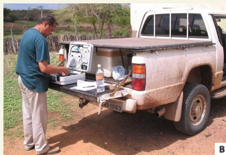
(A) Monitoramento potenciométrico de poço no aquífero Serra Grande, no município de Pedro II (PI); (B) Análise qualitativa das águas dos poços da zona rural do município de Missão Velha (CE).
