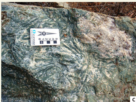
(A) Mina de arenito (formação Serra dos Martins, município Nova Floresta, PB). (B) Dique de basalto, de direção E-W, do magmatismo cretácico Ceará-Mirim (município São Tomé, RN). (C) Bloco de rocha calcissilicática da formação Jucurutu, em mina de scheelita ( \text{CaWO}_4 ) da Umburana (município Currais Novos, RN). (D) Cristal de berilo, encaixado em pegmatito heterogêneo, intrudido em rochas do grupo Seridó (município Campo Redondo, RN) (Folha Santa Cruz, RN-PE).
