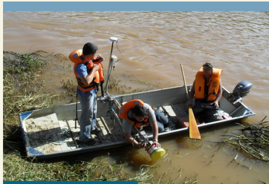
Medição de cheia com Acoustic Doppler Current Profiler (ADCP) na estação de Itaperuna (SP).
