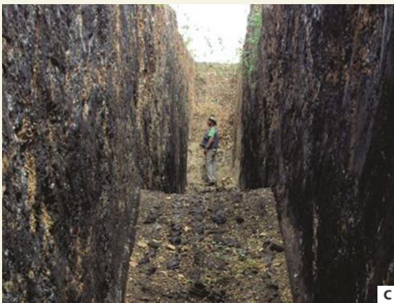
(A) Poço para pesquisa de manganês na localidade de Serragem. (B) Blocos de gondito removidos na fazenda Canafístula. (C) Trincheira escavada para pesquisa de manganês. (D) Aspecto maciço de manganês na parede da trincheira na localidade Lagoa dos Porcos (Folha Baturité, município Ocara, CE).
