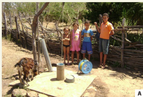
(A) Monitoramento potenciométrico de poço no aquífero Serra Grande, no município de Pedro II (PI); (B) Análise qualitativa das águas dos poços da zona rural do município de Missão Velha (CE).
